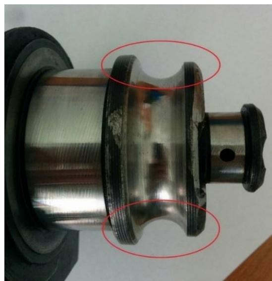
Рис. 1. Дорожка качения лапы трехшарошечного долота
